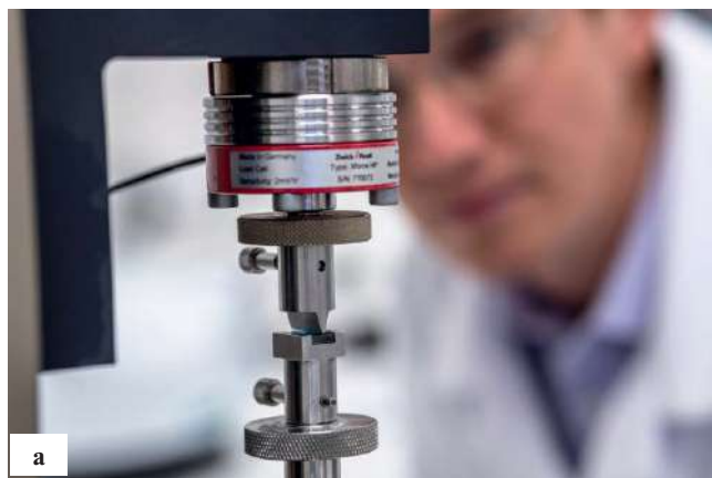
Рис. 2 а, б. Материал для контактных линз проходит испытание на изгибную деформацию в научно-исследовательской лаборатории ООО «Контамак»
